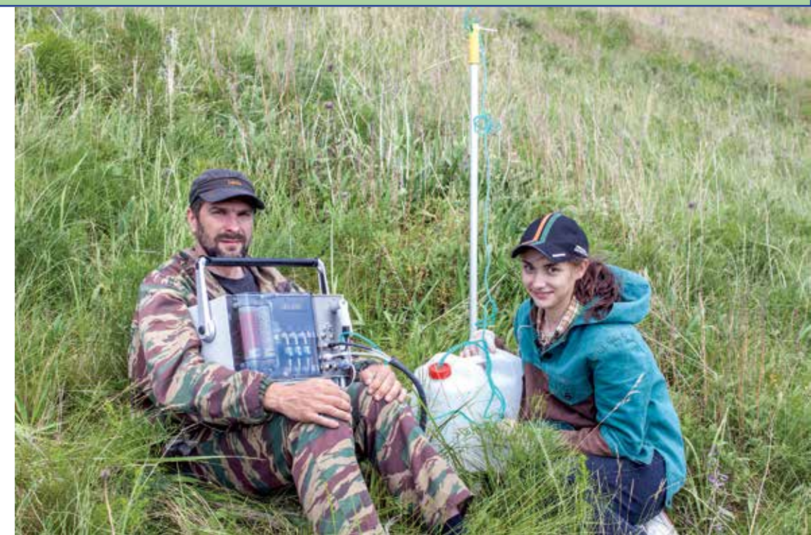
Измерение физиологических параметров растений с помощью портативной системы для изучения газообмена GFS- 3000
